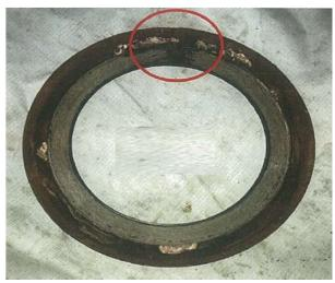
2018年9月に高圧蒸気用コントロール弁フランジ部からの蒸気漏れが発生。ガスケット交換のため開放したところガスケット、フランジ面の傷を確認。フランジ面には縦の傷がある状態で、渦巻きガスケットも一部フィラー(シール材)が抜けている状態だったため蒸気漏れが発生したことが原因と特定いたしました。対応手段としてフランジ修正やフランジ交換等の時間に余裕がなかったため渦巻きガスケットからFISHBONE®ガスケットに変更を決断。
